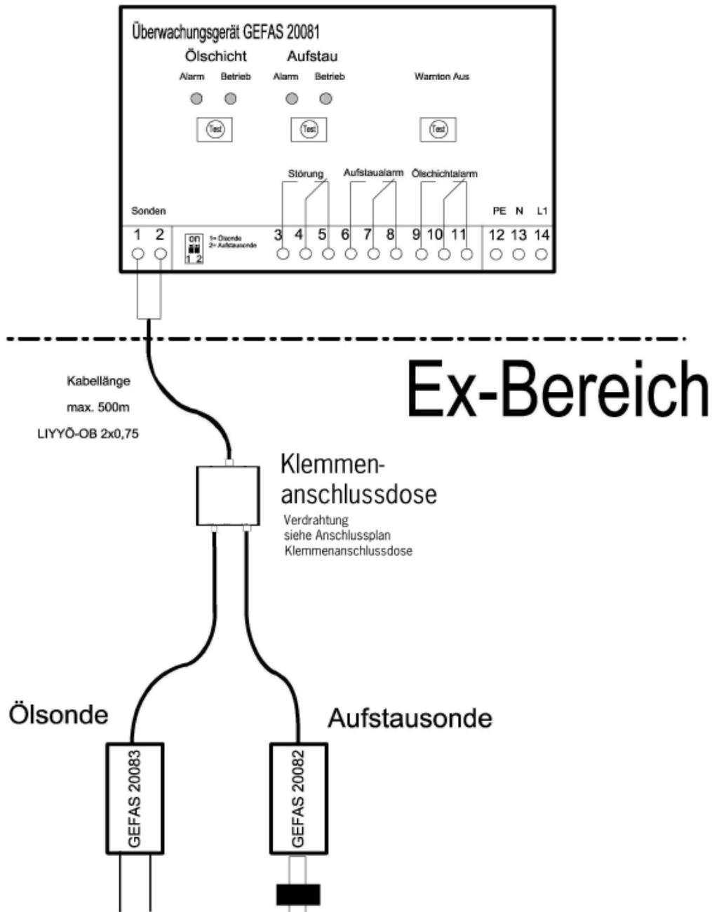
Jenachdem, ob beide Sonden gemeinsam benutzt werden oder ob nur eine Sonde benötigt wird, sind die entsprechenden Wahlschalter im Überwachungsgerät einzuschalten.
